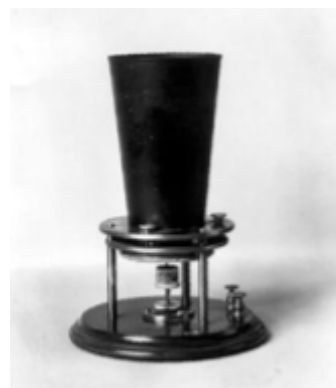
Micrófono “Liquid Transmitter” de Graham Bell . 2
