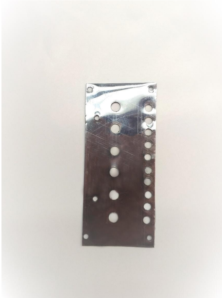
26. Imagen. Frente de aluminio cortado y perforado.
