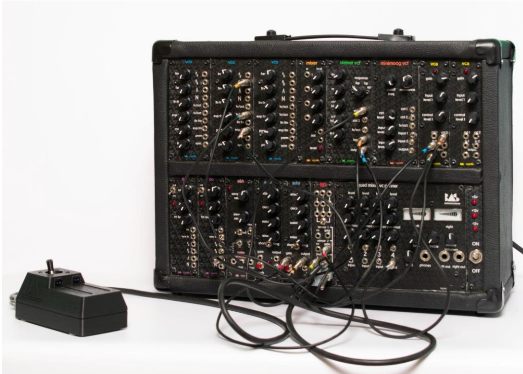
59. Imagen. Sintetizador Modular -483- junto a Interfaz de Control -181- finalizado con cables de conexión.
