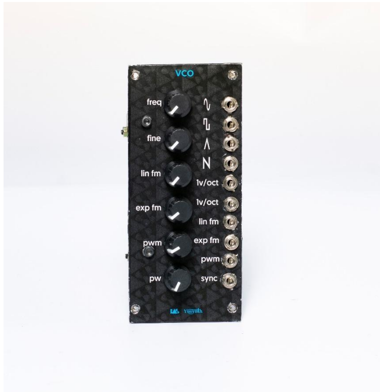
27. Imagen. Frente con serigrafía, componentes montados y cables.
