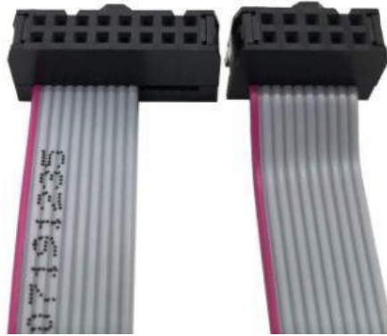
6. Imagen. Cable IDE para alimentación de módulos de sintetizadores en formato Eurorack
