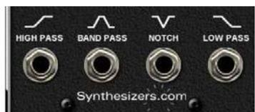
Fragmento del módulo Q107 State variable filter de Synthesizers.com. Los símbolos que representan a cuatro tipos de filtros: pasa altos (*high pass*), pasa banda (*band pass*), eliminador de banda (*notch*) y pasa bajos.
