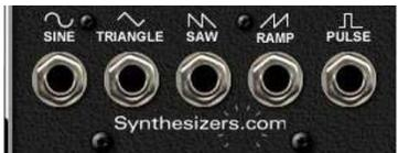
Fragmento del módulo Q106 Oscillator de Synthesizers.com. Los símbolos corresponden a los osciladores de forma de onda sinusoidal (*sine*), triangular (*triangle*), diente de sierra (*saw*), rampa (*ramp*) y pulso (*pulse*).
