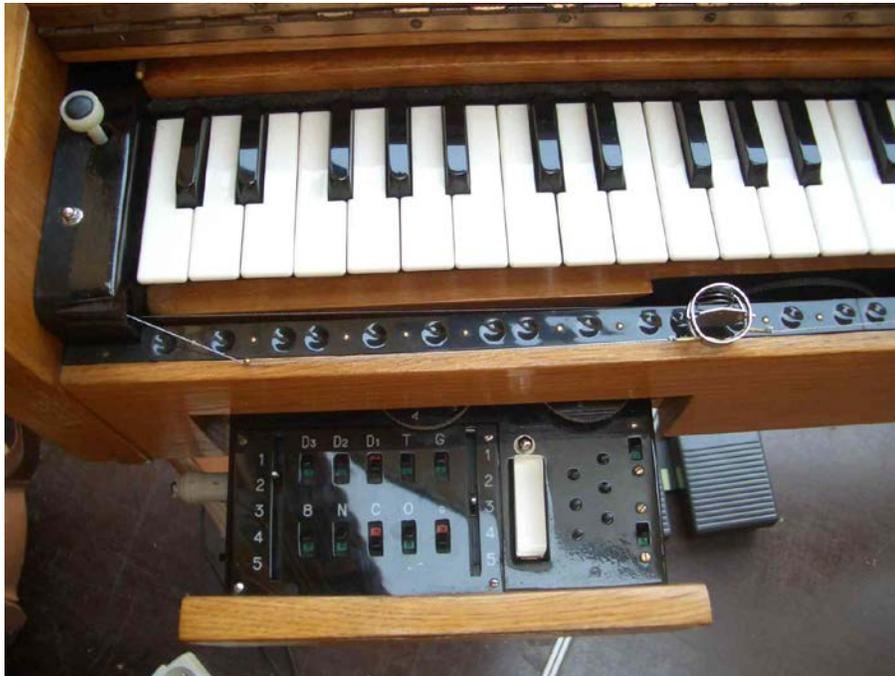
Detalles de los controles del Ondas Martenot: el anillo para deslizar y sus mandos.
