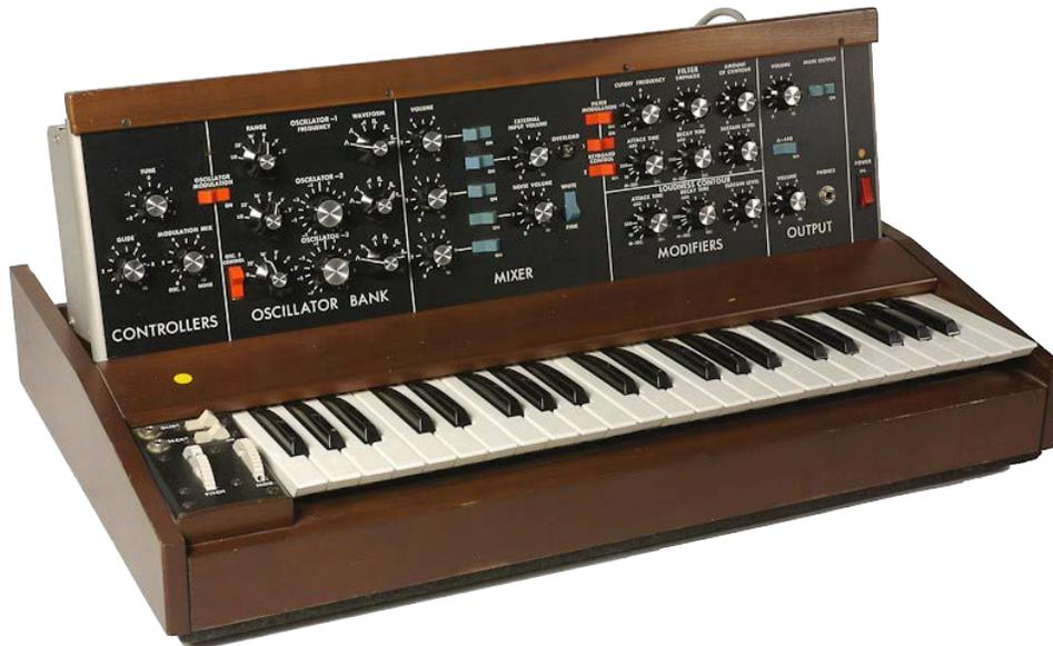
Sintetizador Minimoog Model D: versión reducida del Moog modular, diseñado en respuesta a los músicos de la época, quienes tenían la necesidad de un sintetizador compacto, económico, transportable, simple de usar y musical.
