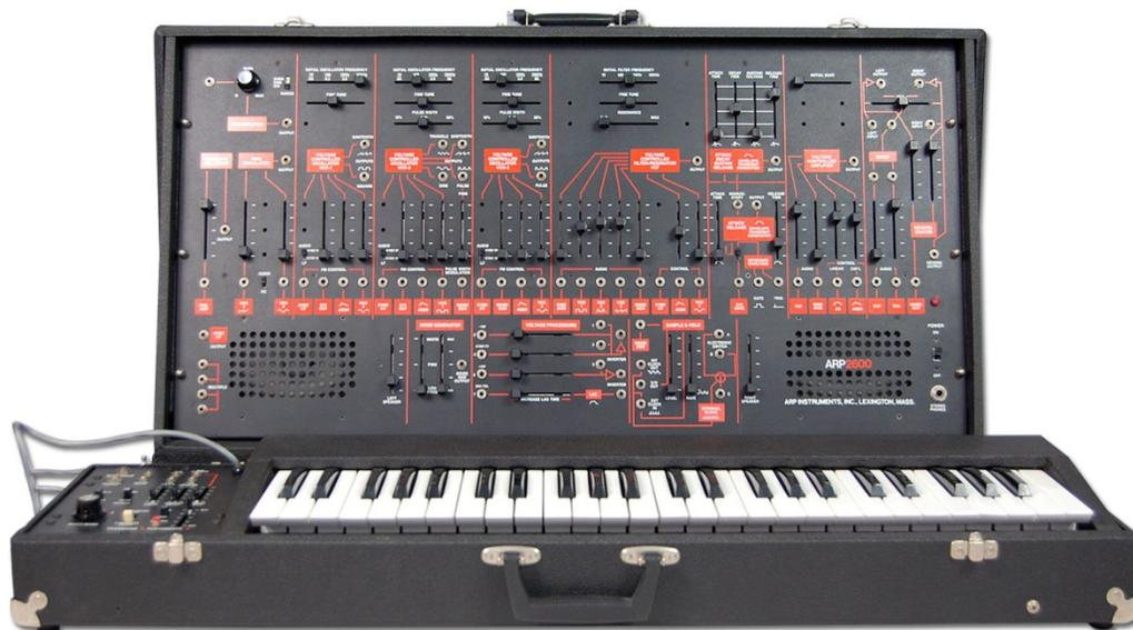
ARP 2600 de ARP instruments. El color naranja contrasta con el negro del fondo, nos ayuda a visualizar los módulos y sus funciones más rápidamente. Las líneas conectoras nos guían a la hora de ubicar los controles.
