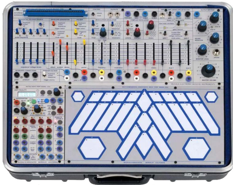
Reedición del sintetizador Buchla Easel-K, lanzado originalmente en 1973. La superficie táctil ubicada en la zona media inferior está compuesta por pads metálicos de excéntricas figuras geométricas.
