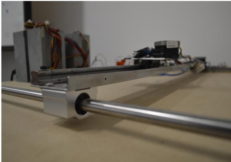
*Imagen 43: Perfil de aluminio montado sobre el rodamiento lineal de bolas recirculantes que se desliza sobre la barra rectificada.*
