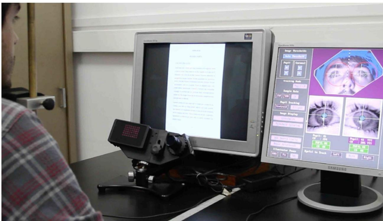
*Imagen 20: Sujeto en situación experimental con la cabeza en la mentonera y frente a él la computadora de presentación y el EyeLink 1000, con el panel emisor de luz infrarroja a su izquierda y la cámara la derecha. Sobre el lado derecho de la imagen, la pantalla de ajustes y configuración. Laboratorio de Neurociencia Integrativa de la UBA, 2014.*
