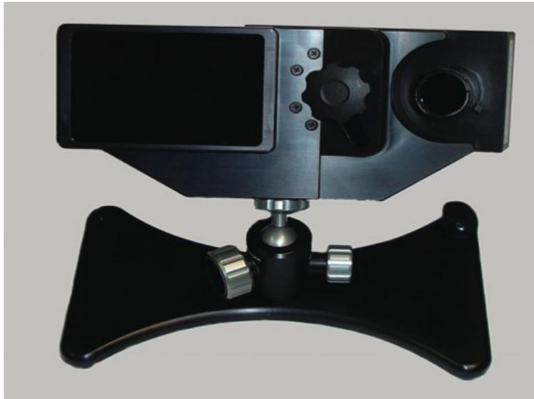
Imagen 18: Imagen del eyetracker utilizado, EyeLink II.
