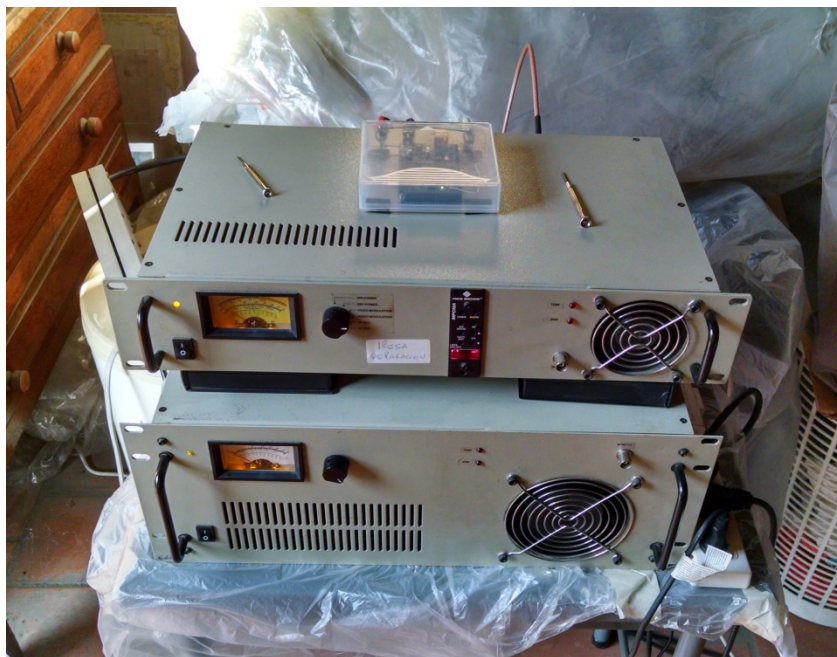
Imagen 43. Estación EMISION / DIFUSION. De arriba a abajo, generador de video y sonido en placa Arduino, unidad moduladora de RF, unidad amplificadora de RF.
