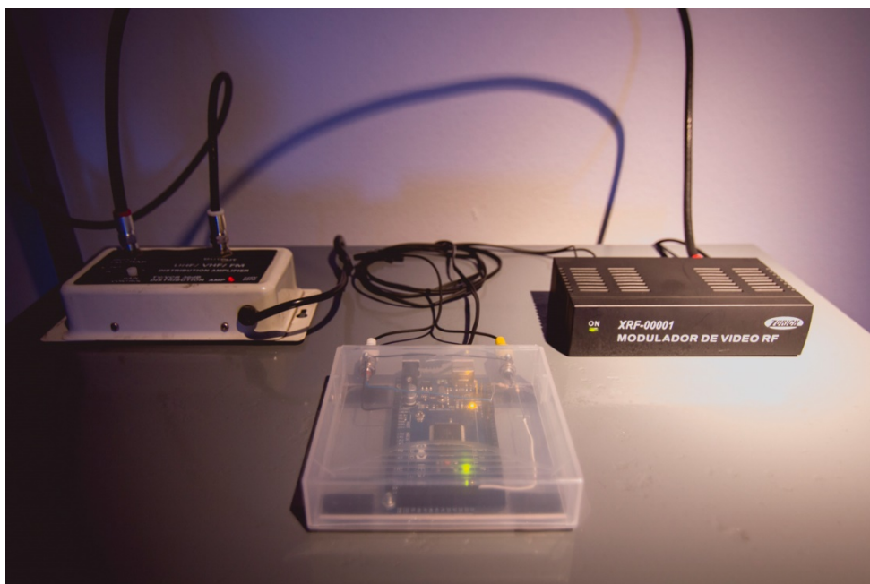
Imagen 33. Detalle de Estación en montaje arteXarte. Abajo centro, generador de audio y video (Arduino MEGA 2560). Arriba derecha, modulador de video y audio en RF. Arriba izquierda, amplificador de señal RF.
