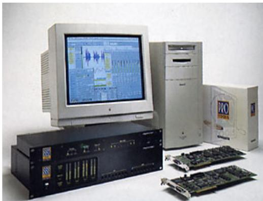
Figura 12: Interfaces de hardware y software Pro Tools IV (1999) junto a la Power Mac G3 Minitower.
