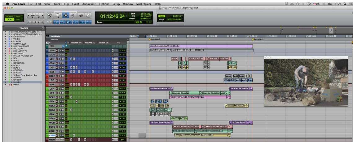
Figura 18: Vista general del flujo de datos de una sesión: regiones, canales agrupados en buses y señalados en colores, la ventana de video.
