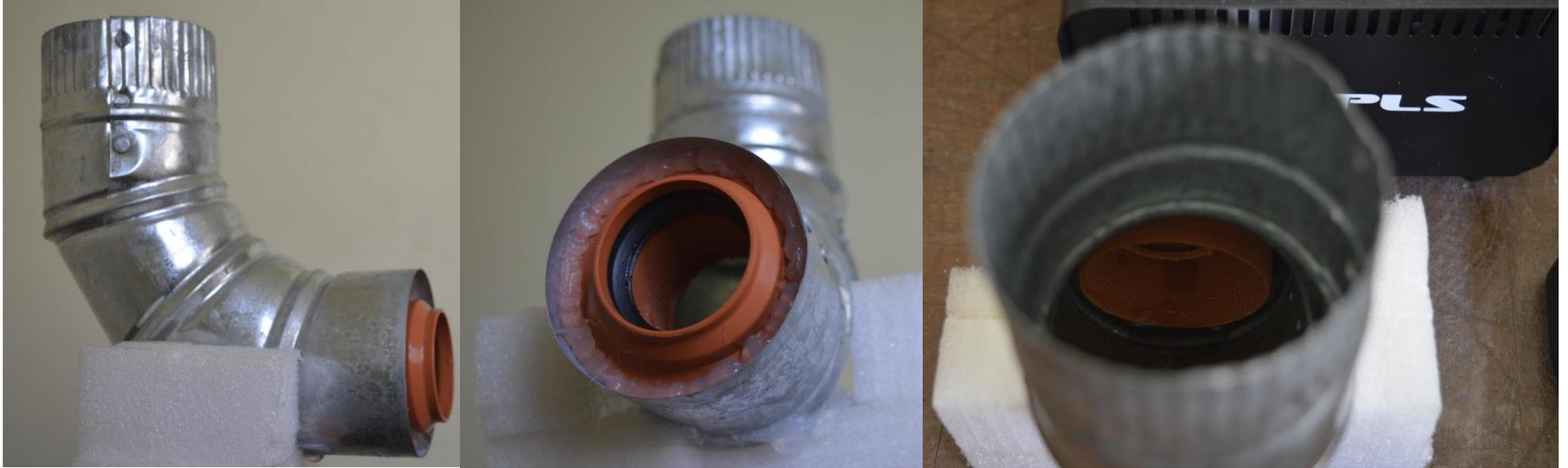
**Ilustración 59: Detalle de conector personalizado**
